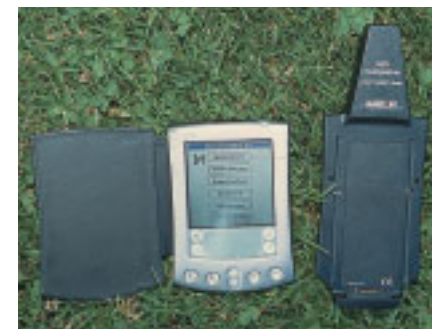
Bei der Klick-On-Bauform wird der Palm in den Empfänger gesteckt und rastet dort ein.
